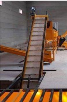
En la Ilustración 3.2, se muestra la segunda maquina donde sigue el proceso se continúa con la siguiente máquina, la que se encarga de recibir toda la nuez recolectada, la cual tiene una banda elevada que tiene como función desplazar la nuez hacia el ardillon.
